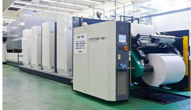
(写真②) オフセット輪転印刷機 小森コーポレーション製
