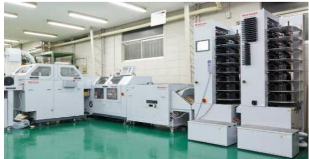
(写真④) 中綴じ製本機 ホリゾン製
