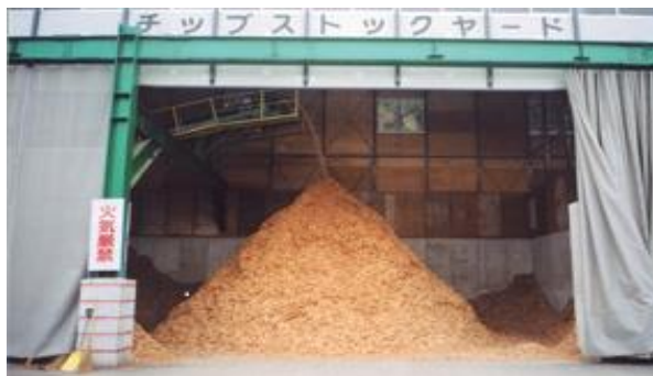
＜施設に持ち込まれた廃材の粉碎処理＞
