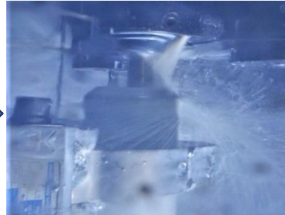
切削加工(切削油使用)
