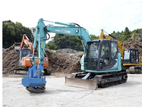
0.25 バックホー（グラブ装置付）6 台
