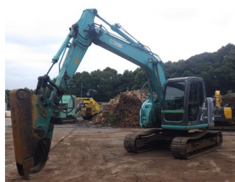
0.45 バックホー（切断機）2 台
