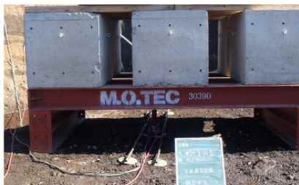
現場での地盤調査(地耐力測定)
