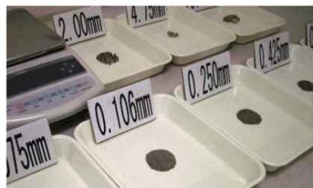
ラボでの土質調査(粒度試験)
