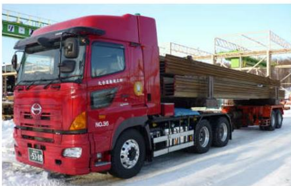
シートパイル 15m ボールトレーラー
