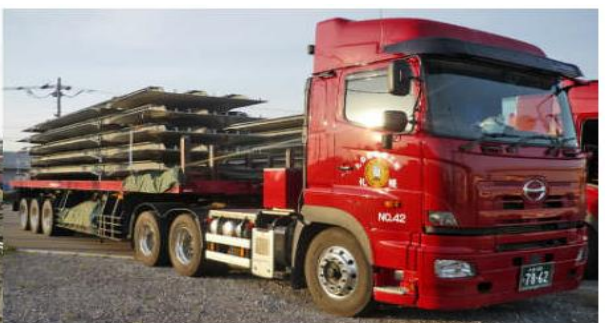
橋梁部材 セミトレーラー 添付群① 保有トラック 当社より提供(以下同様)
