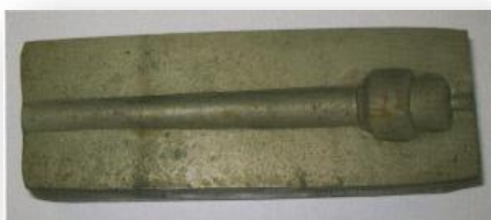
※3:当時使用していた熱感鍛造の型
