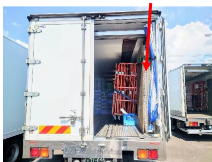
同社 4t 冷蔵冷凍車 荷物室間仕切
