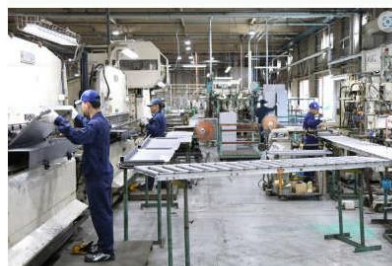
汎用金型による曲げ加工 (NCベンダー・マルチスポット)
