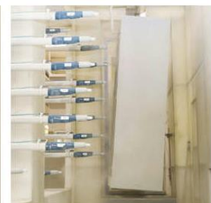
内面・外面部分に対する塗装 (自動塗装機)
