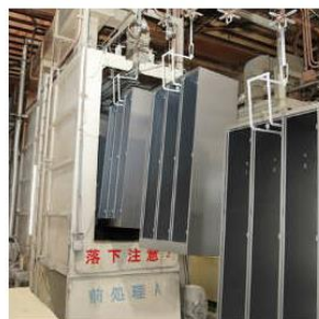
脱脂・化成皮膜処理 (リン酸鉄化成皮膜)
