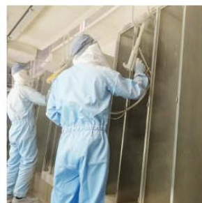
コーナー部分に対する補正塗装 (ハンドガン)
