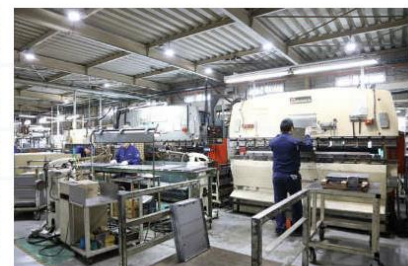
汎用金型による曲げ加工 (NCベンダー・足踏スポット)
