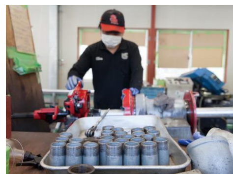
写真⑧ 転造ネジ製作の様子（出田産業提供）
