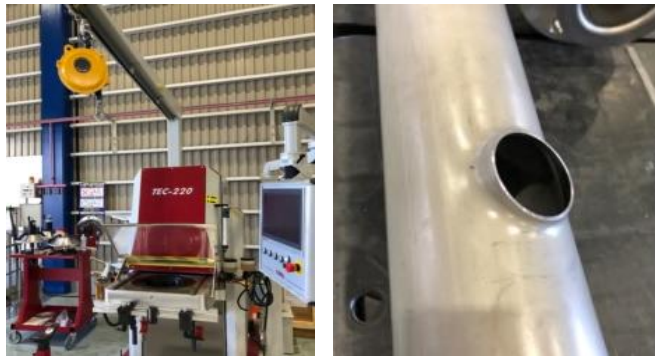
写真⑨ バーリングマシンと同マシンで加工した配管（出田産業提供）
