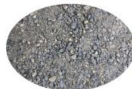
各種碎石・砕砂… (使用例) アスファルト合材、生コン、コンクリート二次製品
