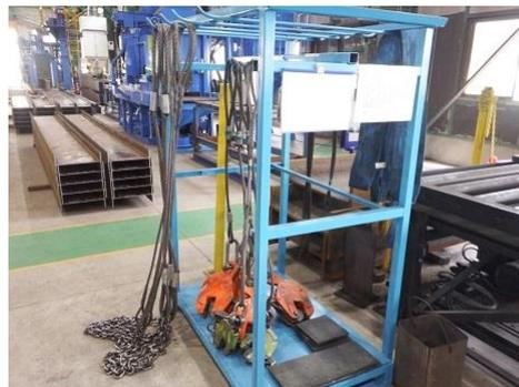
残材で製作した「吊具整理ラック」
