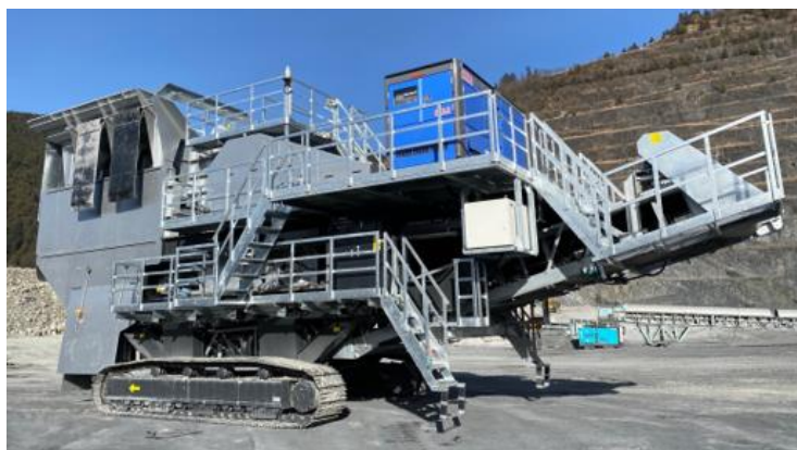
[国内初のバッテリー搭載型の自走式クラッシャー]
