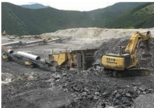
地盤を破碎し、岩石を破碎機でこぶし大に砕く
