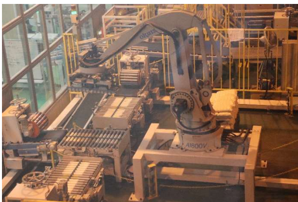
1時間に1,200個の米袋を積み上げるロボットパレタイザー（左）と正確に荷積みされた精白米（右）
