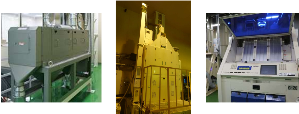
異物除去を行う設備（左：粗洗機、中：石抜機、右：色彩選別機）
