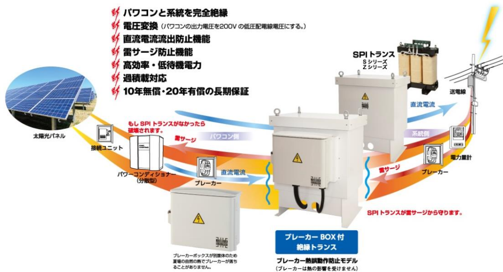
＜SPIトランスの概略図＞
