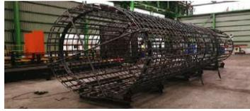
場所打ち杭用の鉄筋かごを編成する設備。
