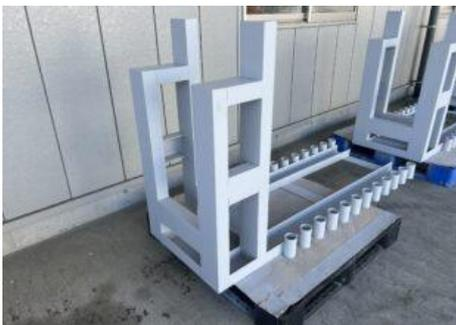
マテハン装置油圧配管サポートフレーム
