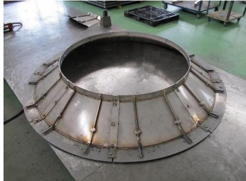
ステンレス中厚板の加工。送り円錐曲げの例。
