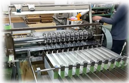
<スチール板のカット（スリット）>
