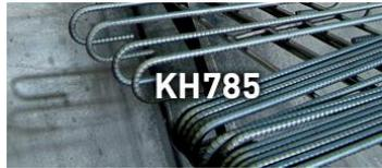
スーパーフープ (KH785) とは、岸和田製鋼が開発した 785N/mm<sup>2</sup>の降伏点と 930N/mm<sup>2</sup>の引張強度を有する国土交通省大臣認定の高強度鉄筋であり、普通鉄筋に比べ 3 倍弱の強度を持つ、主に RC 建築構造物の柱・梁に使用される高強度せん断補強筋。
