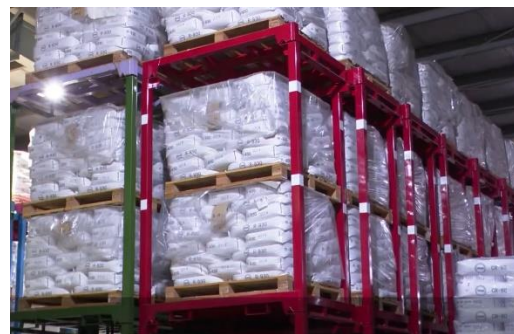
物流支援機器ネステナー 5段の段積みを実現
