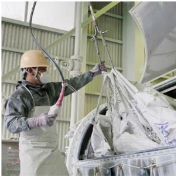
■フレコンバック洗浄作業
