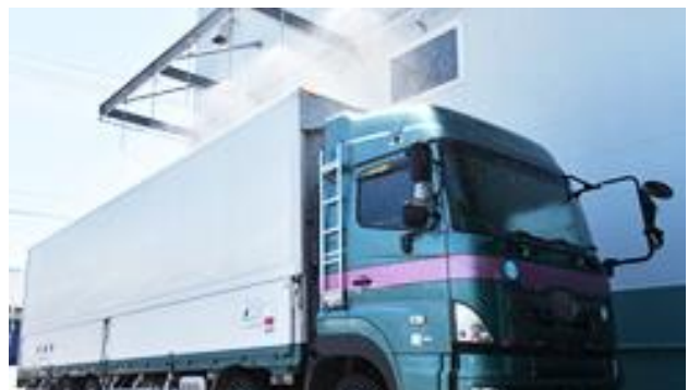
写真⑦ 噴水装置による水漏れチェックの様子 （出典：藤伸 web サイトより）
