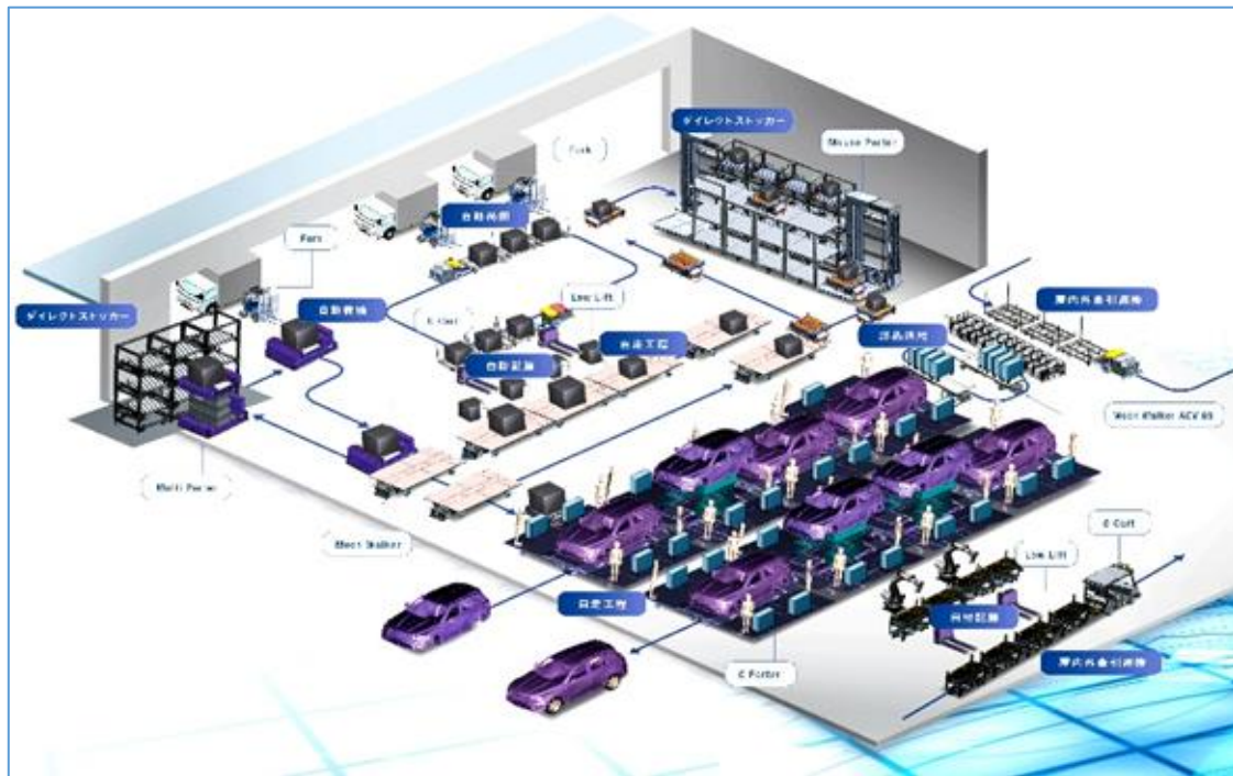
(図表①) AGVを主体とした搬送システム
