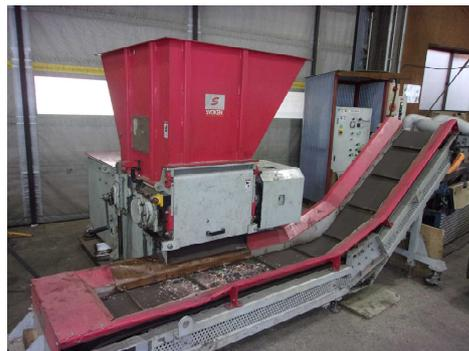
③一次破碎後ベルトコンベアで次工程へ
