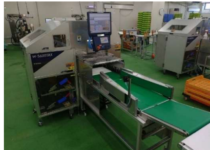
(当社より) 左：焼き鳥自動串差し機、右：高速値付け機
