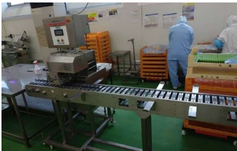
(当社より) 左：焼き鳥自動串差し機、右：高速値付け機
