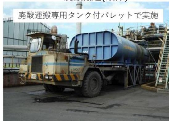
廃酸運搬専用タンク付パレットで実施
