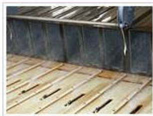
1. 洗浄機で氷の型枠を洗浄
