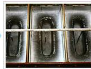
3. 空気で攪拌しながら長時間かけて透明で溶けにくい氷に仕上げます
