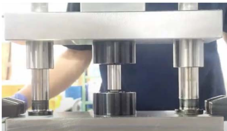
写真：カシメ接合の作業風景
