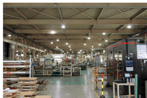
<LED照明に切り替えた本社三重工場>
