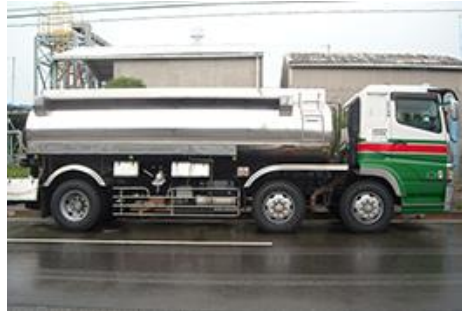
・10t タンクローリー
