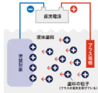
(図表①) カチオン電気溶接のしくみ
