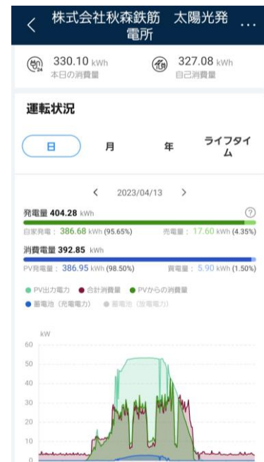
▲太陽光発電と電力消費状況
