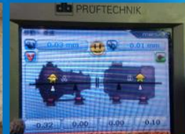
レーザー軸芯出し機 (OPTALIGN SMART) による軸芯の調芯
