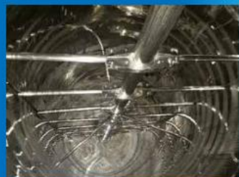
晶析塔 概寸: \Phi 3200 \times 12000\text{H} (冷水ジャケット式)
