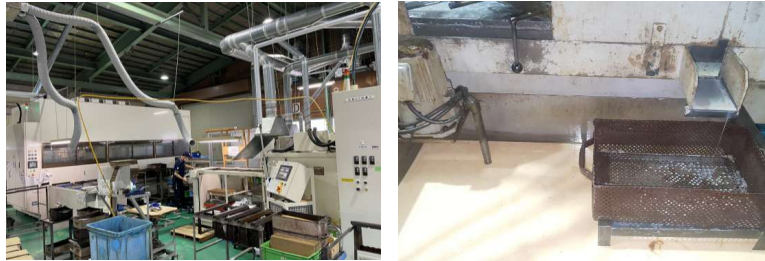
(当社より) 左：炭化水素系洗浄材を使用した洗浄機、右：切削油の循環利用の様子
