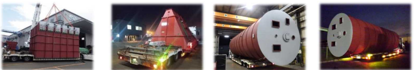
倉敷市西部クリーンセンター 集塵機・飛灰貯槽
