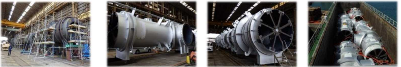
千葉 第6高炉3次改修 熱風本管製作 JFEスチール東日本製鉄所 (千葉地区) 西工場第6 溶鋳炉
