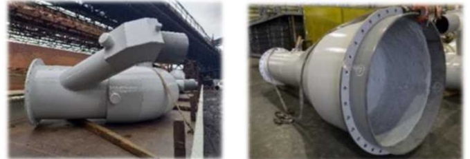
DL-7中継所集塵機建設 集塵ダクト、架構等製作 JFEスチール西日本製鉄所 (倉敷地区) コークス工場
