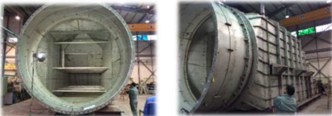
脱硫設備用大型ダクト (韓国)
