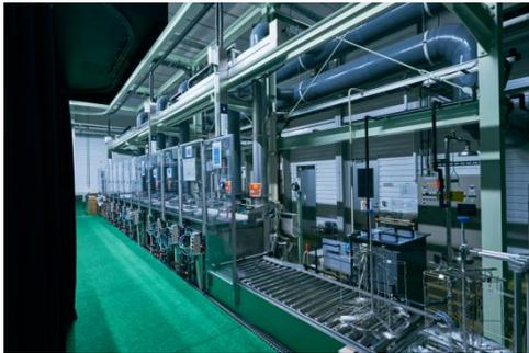
脱脂・エッチング付蛍光浸透探傷装置
