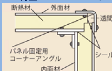
▲一般的な荷室フレーム断面
