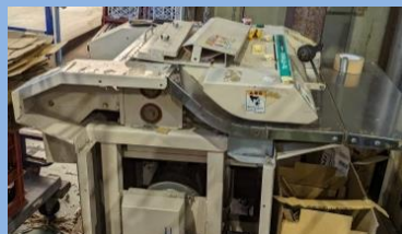
▲ 梱包資材は細かく刻んで緩衝材として再利用 廃棄される梱包資材の3割の削減を実現
