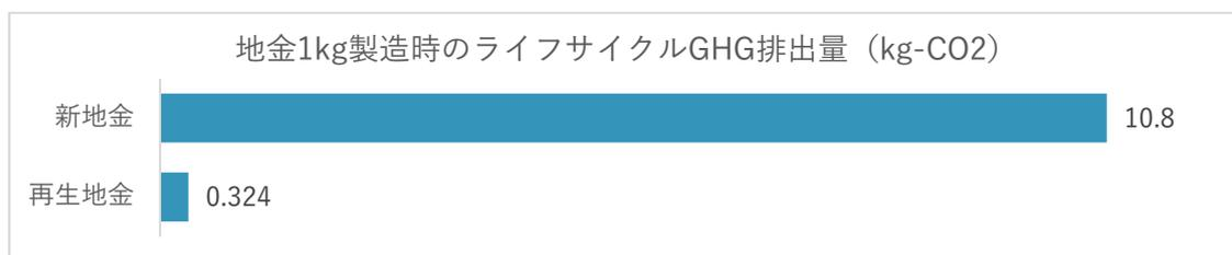
図 2：地金 1kg 製造時の GHG 排出量の比較<sup>10</sup>
