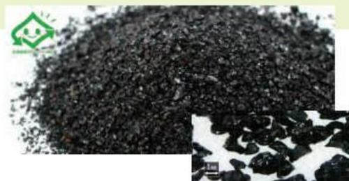
銅を精錬する過程で、鉄分・石灰石・珪石が結合した銅スラグを粒度調整したプラスト材を再生しています。鉄分が多いため高密度で、非常に硬いのが特徴です。
