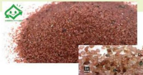
天然鉱石であるガーネットを使用したプラスト材を再生しています。高密度で重く、また非常に硬い結晶であることで屋外作業やスケール剥離、塗装剥離等の用途に適しています。
