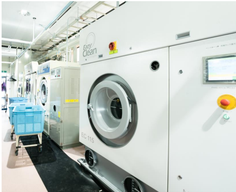
▲溶剤を毎回蒸留可能な最新鋭のクリーニング機
