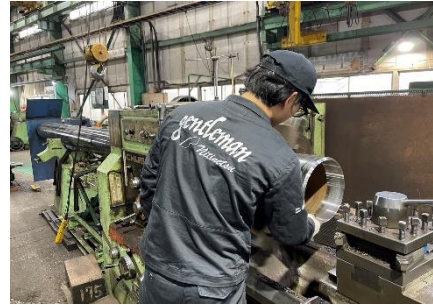
芯間3M、スピンドル径Φ322貫通旋盤
