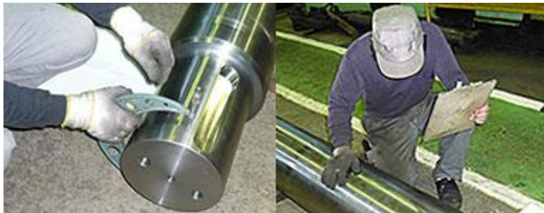
写真3 加工後検査、出荷時検査の様子
