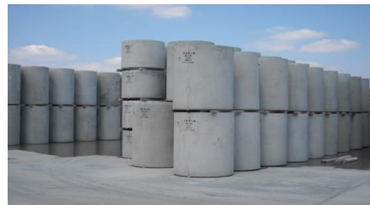
ラダホール直壁 (マンホール)
