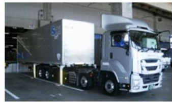
【スワップボディコンテナ車両】 (出典：国土交通省生産性革命プロジェクト(第4版))
