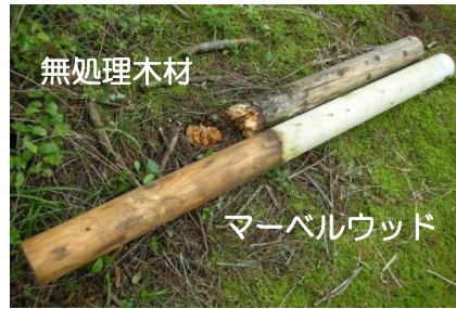
▲防腐・防蟻試験の様子
