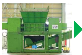
破砕機による切断処理
