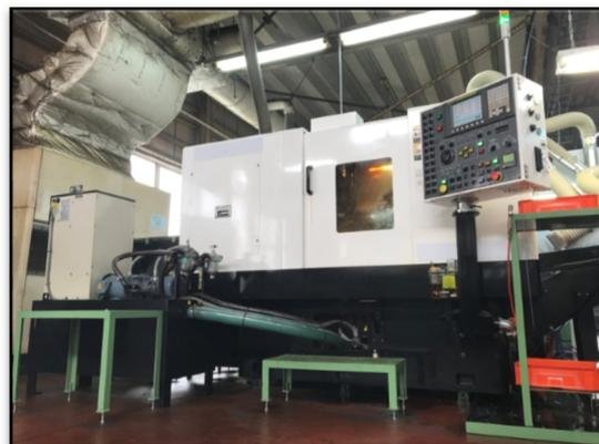
NC 旋盤6軸加工機
