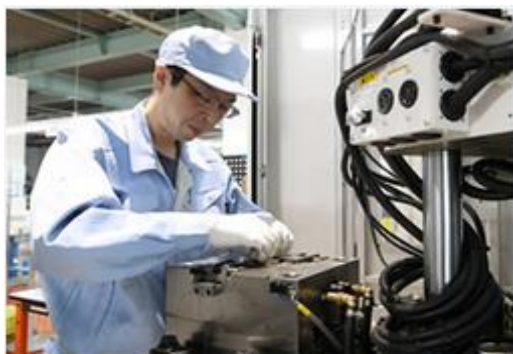
〈インサート成形加工の様子〉
